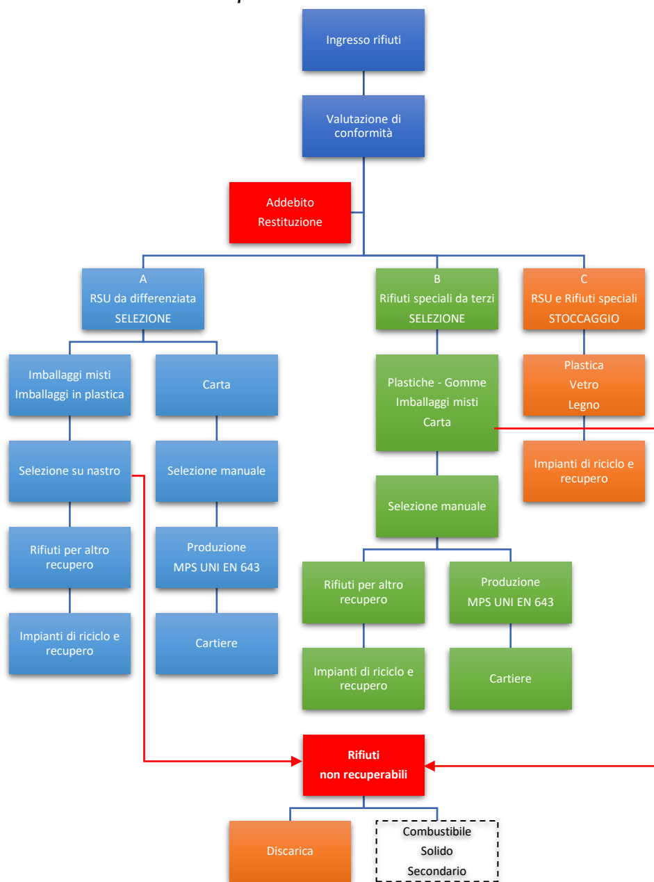
Figura 6 Diagramma di flusso delle attività dell'impianto 3
