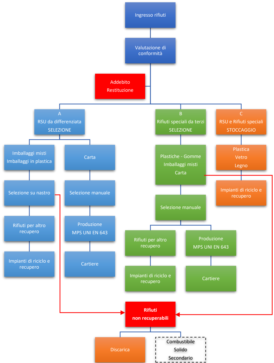
Figura 6 Diagramma di flusso delle attività dell'impianto 4
